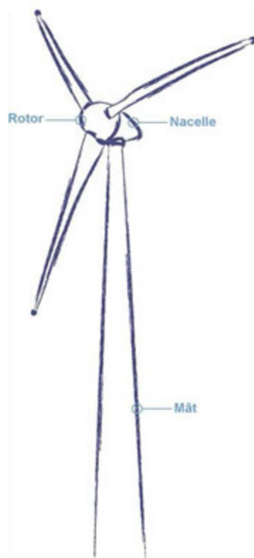
Figure 1 : Représentation simplifiée d'une éolienne
